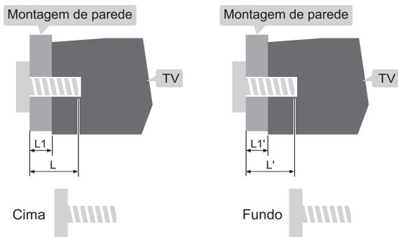
L1: Espessura de montagem na parede
