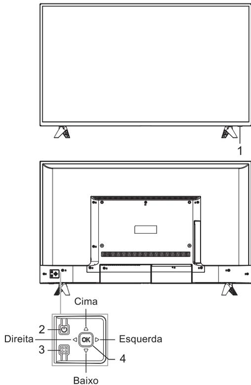
1. Indicador LED de alimentação e sensor de recepção do controle remoto.
