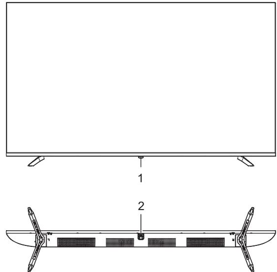
1. Indicador LED de alimentação e sensor de recepção do controle remoto.
